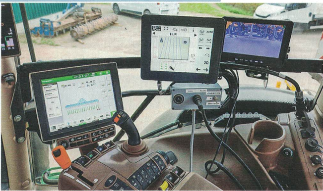
Volle Hütte: Die Steue- rung läuft über ein Iso- bus-Terminal (links), der Verschieberahmen hat eine eigene Bedien- einheit. Darunter sitzt das Bedienpult für die manuelle Steuerung.
