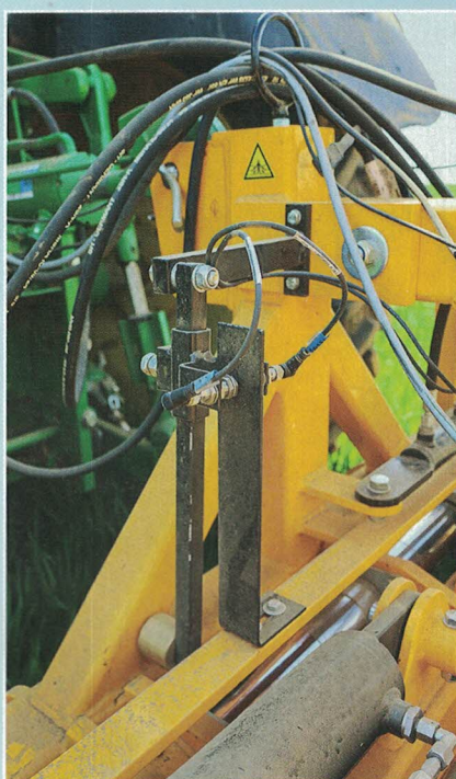
Der Neigungssensor ist einfach und dadurch wenig störanfällig.
