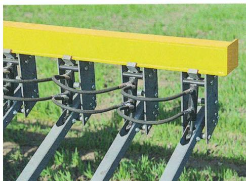
Vorne drehen die Lenker in kugelgelagerten Drehpunkten. Die Hydrozylinder sind Option.
