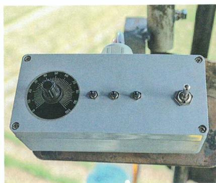
Der Drehregler steuert den Schardruck, die Kippschalter die Teilbreiten und die Klappung.
